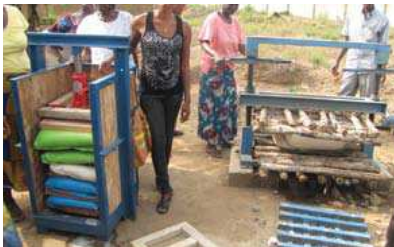
Une presse hydraulique (à gauche) ou une presse à vis (à droite) : on les voit ici à l'extérieur de l'usine.
